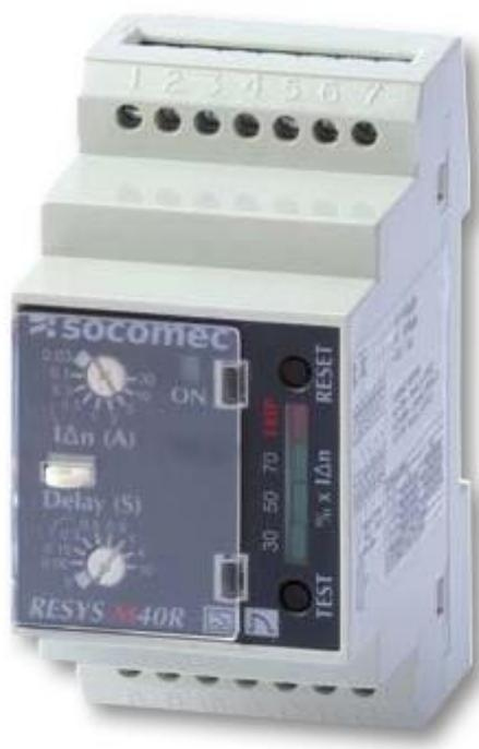
**RESYS M40R** — реле утечки на землю Socomec RESYS M40R тип А, в сочетании с устройством дистанционного отключения, предназначено для защиты от непрямого контакта, ограничения токов утечки и повторное включение устройства дистанционного отключения после определения утечки тока и отключение питания. Это решение для энергораспределения, водоподготовки, различных процессов, сельского хозяйства и уличного освещения, а также телекома и телевидения.
